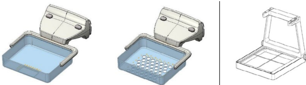
Εικόνα 151: Πίεστρα κατάλληλα για τοποθέτηση συρμάτινου οδηγού.
