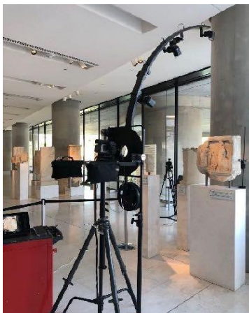
Εικ. 14β. Ρομποτικός βραχίονας νέου σχεδιασμού και τεχνικής ελεγχόμενης περιστροφής φωτιστικών σωμάτων γύρω από μεταβλητού μήκους άξονα, όπως χρησιμοποιήθηκε σε φωτογράφιση επιγραφών εντός του εκθεσιακού χώρου του Μουσείου Ακρόπολης.
